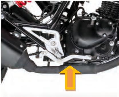
Appuyer sur cette pédale pour actionner le frein : le témoin de freinage s'allume simultanément.
