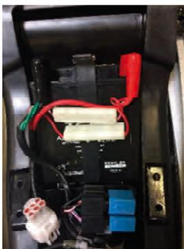
Le boîtier à fusible se situe sous la selle. Les fusibles assurent la protection de l'ensemble du circuit électrique. En cas de défaillance de ce dernier, commencer par vérifier si le fusible n'est pas grillé. Dans ce cas, le remplacer par un fusible de rechange.
