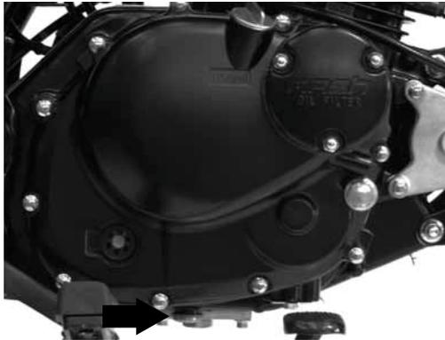
4. Serrer la vis de vidange et remplir le réservoir d'huile en y ajoutant la quantité d'huile nécessaire, avant de resserrer doucement le bouchon supérieur.
