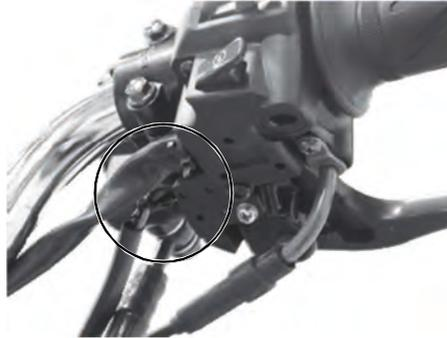
Le contacteur du feu stop avant se situe en dessous du levier de frein. Dévisser la vis, puis déplacer le contacteur, si besoin est dans un sens puis dans l'autre, jusqu'à ce que le feu s'allume à la moindre pression sur le frein (dans tous les cas, avant que le levier ne soit serré au maximum).
