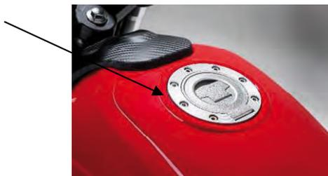
Pour ouvrir le bouchon du réservoir, insérer la clé et la tourner dans le sens horaire. Le bouchon peut alors être retiré avec la clé. Pour remettre le bouchon en place, aligner les flèches figurant respectivement sur le bouchon et sur le réservoir, puis, la clé étant enfoncée, exercer une pression sur le bouchon jusqu'à ce qu'un déclic se fasse entendre. Retirer ensuite la clé :
